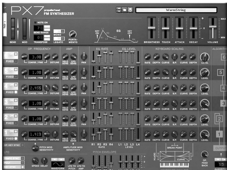
Figura 18. Interfaccia utente del Propellerhead PX7 FM Synthesizer, un sintetizzatore a sintesi di modulazione di frequenza (FM) a 6 operatori ispirato al classico Yamaha DX7, configurato sulla patch “WarmString”.
